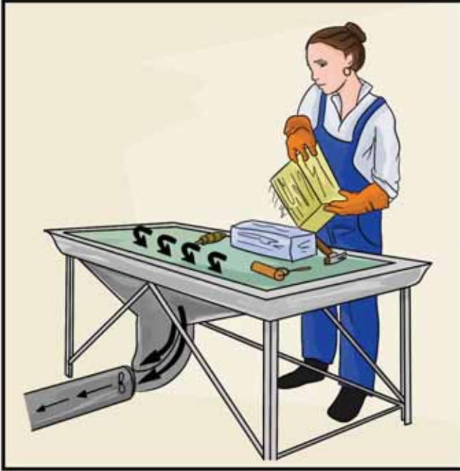
شكل ٢٣. هاهما طريقتان للتهوية الموضعية. في الرسم الأيسر، جُذِبَت الملوثات إلى منضدة العمل قبل بلوغها الحيز الذي يتنفس ضمنه العامل. في الرسم الأيمن، سُجِبَ الدخان الناجم عن اللحام إلى الجهاز العادم (الطارد للهواء)
