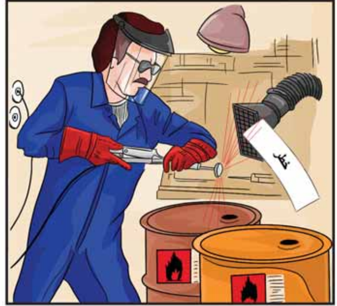
شكل ١٩. قد يسبب اللهب المكشوف لمشعل اللحام أو القطع اشتعال الأبخرة القابلة للاشتعال
