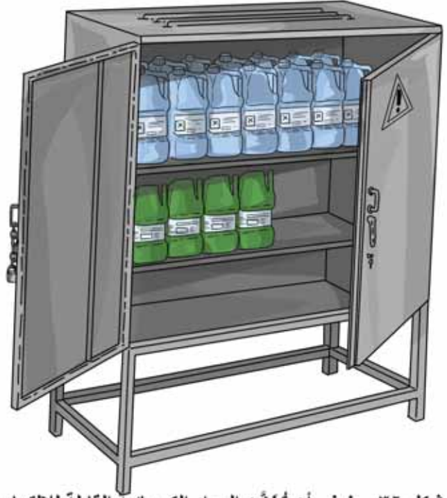
شكل ٣٦. ينبغي أن تُخزَّن المواد الكيميائية القابلة للاحتراق في أماكن باردة وجيدة التهوية، وبعيدا عن المصادر الممكنة للاشتعال (شكل ٣٦).
